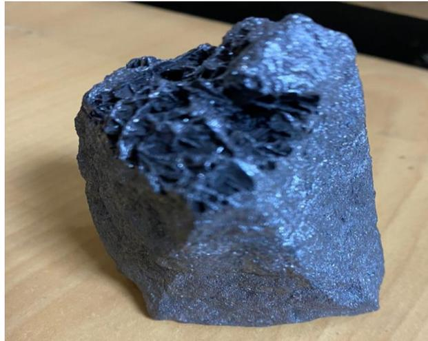
*Ilustración 04, Pieza de Ferrosilicio. Fuente: Empresa Fundiciones Imperial (Apablaza), Concepción.*
