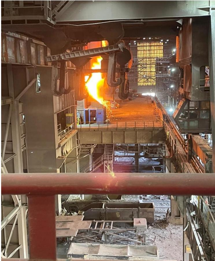
*Ilustración 23, Vaciado de Arabio y otros minerales en el cucharón en la fabricación de Acero
