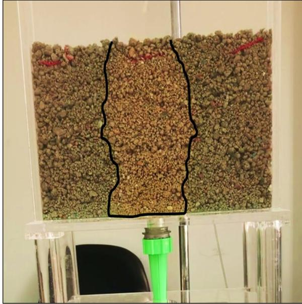
Figura 11 Fotografía Columna regada Carga 1 sin sufusión.
