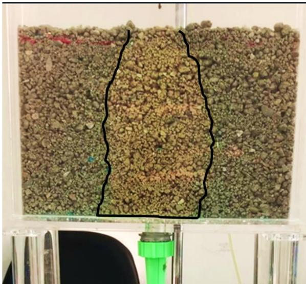
*Figura 16 Fotografía Columna regada Carga 2 con sufusión.*
