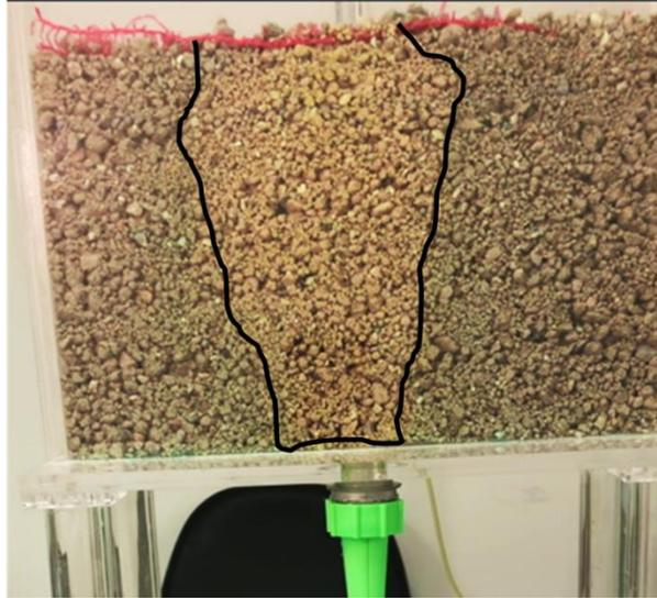
*Figura 15 Fotografía Columna regada Carga 1 sin sufusión.*
