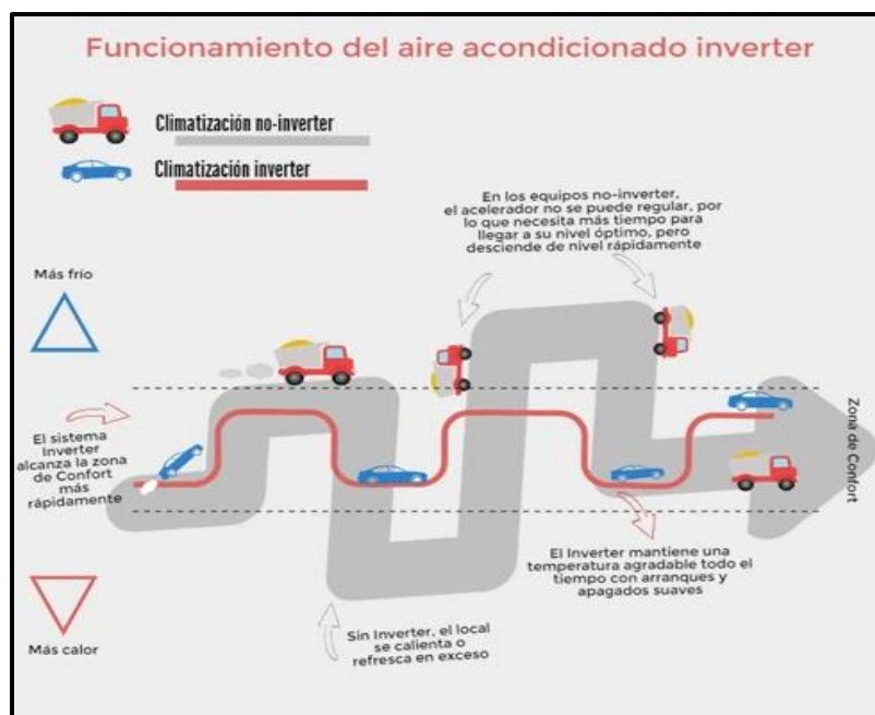
Imagen N°23, Funcionamiento tecnología inverter en aires acondicionados.
