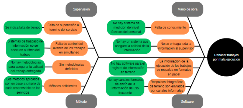
Ilustración 37: Diagrama Ishikawa rehacer trabajos por mala ejecución
