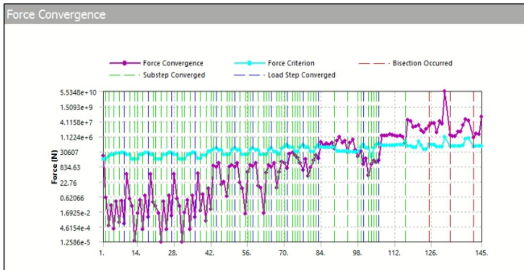
**Figura 54.** Convergencia de substeps del modelo 4 en ANSYS.
