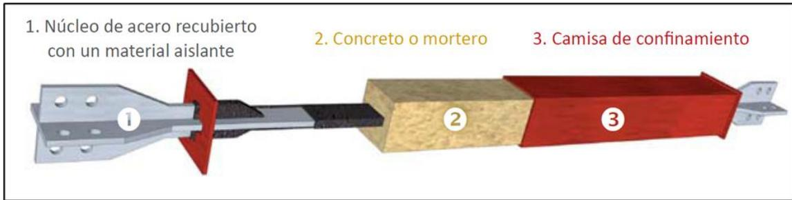
**Figura 9.** Componentes de un BRB tipo. Fuente: Hussain & Kim, 2023
