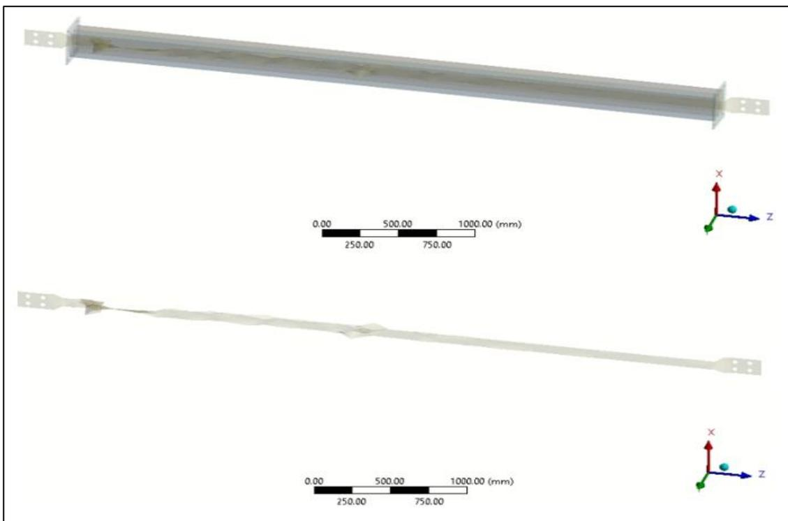
**Figura 44.** Deformación plástica en la zona de fluencia del núcleo de acero en ANSYS. Fuente: Propia.
